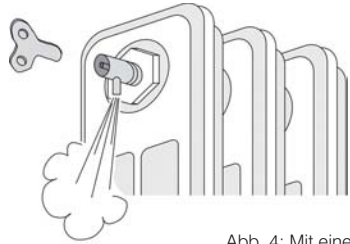
Abb. 4: Mit einem Entlüftungsschlüssel lässt sich die Luft im Heizkörper ganz einfach ablassen.
