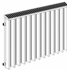
Lamellenradiator (heute nur noch im Altbau)
