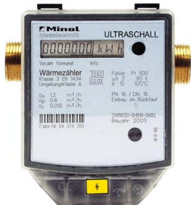
Abb. 1: Beispiel für das Rechenwerk eines Ultraschall-Wärmezählers.
