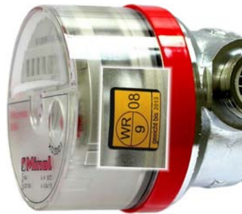
Abb. 5: Eichmarken sind auf dem Messgerät manipulationssicher angebracht.
