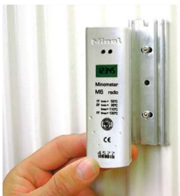
Abb. 17: Elektronische Heizkostenverteiler haben immer andere Bewertungsfaktoren, als vormals eingebaute Verdunstergeräte.
