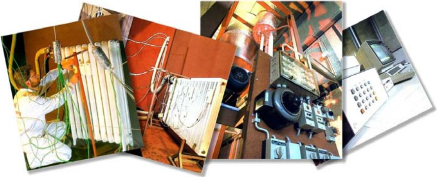
Abb. 12: Der Minol Heizkörperprüfstand nach DIN 4704. Hier werden die exakten Wärmeübergangswerte für alle Heizkörper und Heizkostenverteiltertypen gemessen.
