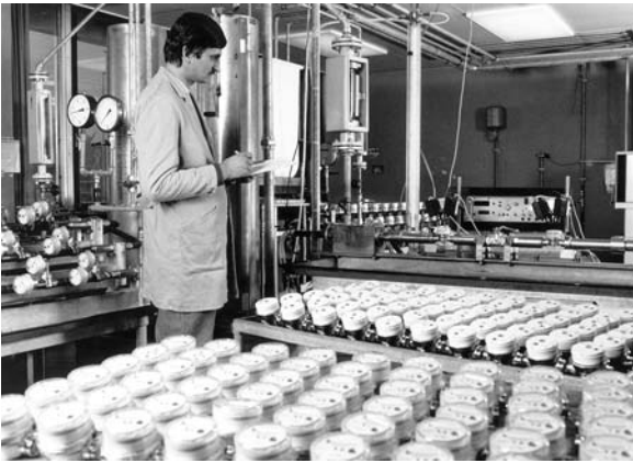
Abb. 3: Ergänzend zur Einzelprüfung werden auch Messungen auf einem Reihenprüfstand vorgenommen, bei dem jedes Gerät auf zulässige Toleranzen getestet wird.
