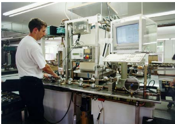
Abb. 16: Prüfung von Wasserzählern auf Genauigkeit entsprechend den Vorgaben des Eichgesetzes.
