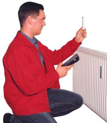
Abb. 1: Der Ableser des Messdienstes hält das Vorderteil des Heizkostenverteilers gegen das Licht, um den Ablesepunkt genau erkennen zu können.
