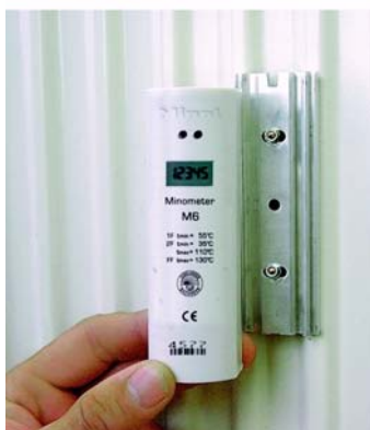
Abb. 5: Ideal zur Nachrüstung. Sind Heizkostenverteiler vom Typ Minotherm II vorhanden, erfolgt der Austausch gegen den elektronischen Heizkostenverteiler Minometer M 6 mit einem Handgriff.
