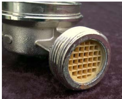
Abb. 8: Siebe im Einlauf von Wasserzählern verhindern das Eindringen grober Schmutzpartikel. Kalkablagerungen und Rostschlamm können sie aber auch nicht verhindern.
