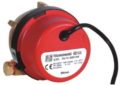
Abb. 6: Beispiel für einen Flügelradzähler als hydraulischen Geber zu einem Wärmezähler. Die Impulse für den Heißwasserdurchfluss werden per Kabel an das elektronische Rechenwerk gesendet.
