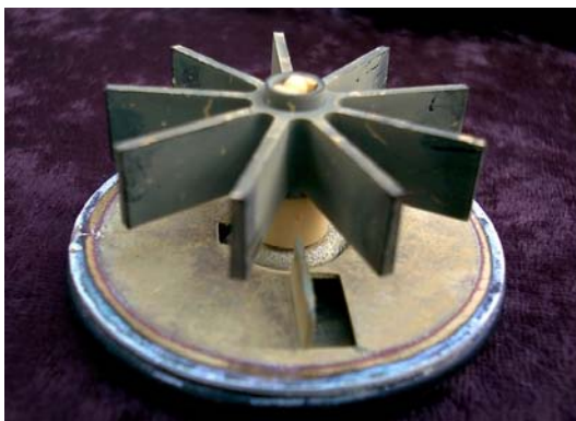
Abb. 7: Die Einsatzdauer eines Wasserzählers hängt auch von den örtlichen Wasserqualitäten ab. In diesem Fall war die Flügelradachse so verkalkt, dass der Zähler völlig blockierte und nichts mehr zählte.
