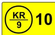
Eichmarke der Prüfstelle KR9 (K für Wärmezähler, Minol in Sachsen). Die letzte Eichung war 2006.
