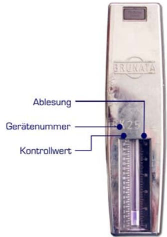
Abb. 13: Ablesung eines Warmwasserkostenverteilers.
