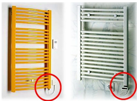
Abb. 5: Badheizkörper mit elektrischen Heizpatronen können nicht mit Heizkostenverteiltern erfasst werden.
