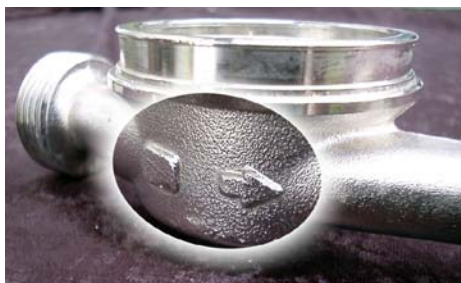
Abb. 8: Der Richtungspfeil auf oder in dem Gehäuse des Wasserzählers ist wichtig. Falsch herum eingesetzte Wasserzähler entsprechen nicht dem Eichgesetz.
