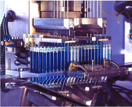
Die Befüllung der Ampullen von Heizkostenverteilern erfolgt präzise auf einer vollautomatischen Anlage.
