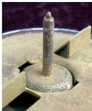
Abb. 7: Die Einsatzdauer eines Wasserzählers hängt auch von den örtlichen Wasserqualitäten ab. In diesem Fall war die Flügelradachse so verkalkt, dass der Zähler völlig blockierte und nichts mehr zählte.
