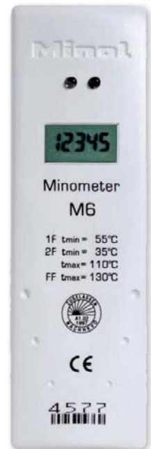
Abb. 11: Elektronische Heizkostenverteiler gibt es heute mit Funkdatenübermittlung. So ist nicht einmal mehr das Betreten der Wohnung zur Ablesung erforderlich.
